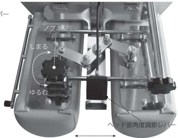
ノブネジをゆるめる事で、ロックが解除されヘッドの幅を
