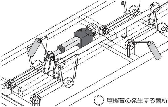
● 付属のグリーススプレーで3ヶ月を目安に可動部分に適量吹き付けてください。給油を怠ると、がたつきや摩擦音の原因となります。
