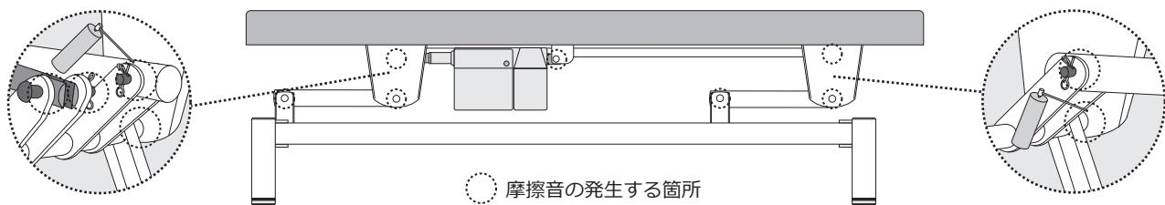
●付属のグリーススプレーで3ヶ月を目安に可動部分に適量吹き付けてください。給油を怠ると、がたつきや摩擦音の原因となります。
