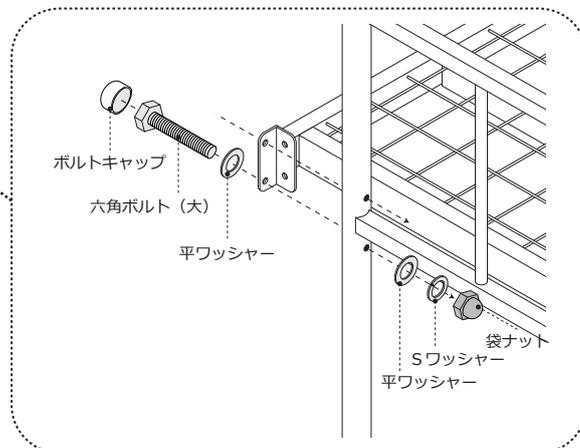
※ボルト締め付け後、ボルトキャップを取り付けてください。
