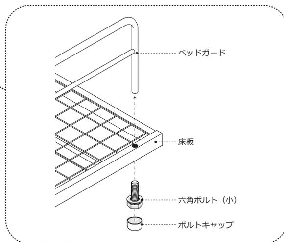
※ボルト締め付け後、ボルトキャップを取り付けてください。
