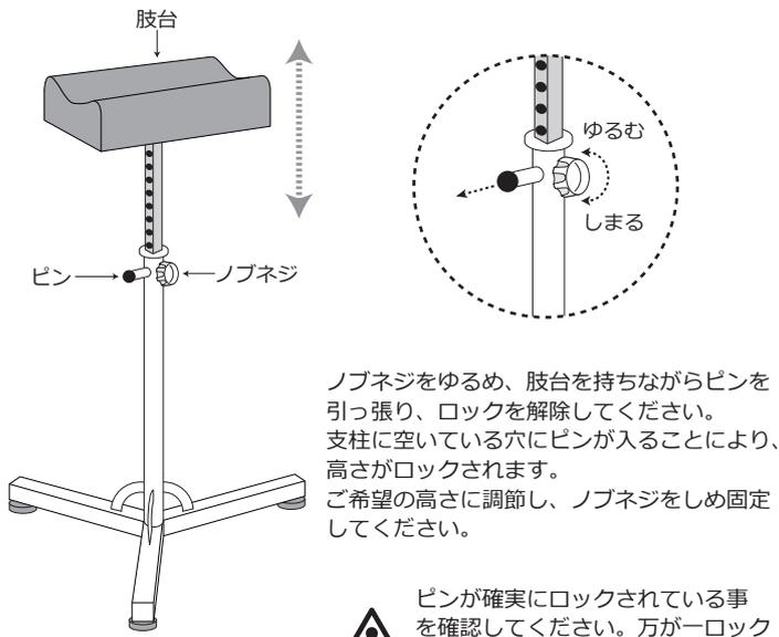
ノブネジをゆるめ、脚台を持ちながらピンを引っ張り、ロックを解除してください。支柱に空いている穴にピンが入ることにより、高さがロックされます。ご希望の高さに調節し、ノブネジをしめ固定してください。
