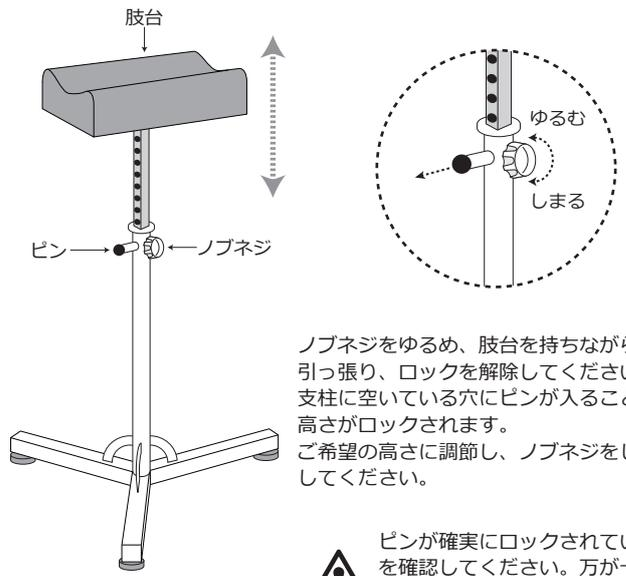
ノブネジをゆるめ、脚台を持ちながらピンを引っ張り、ロックを解除してください。支柱に空いている穴にピンが入ることにより、高さがロックされます。ご希望の高さに調節し、ノブネジをしめ固定してください。
