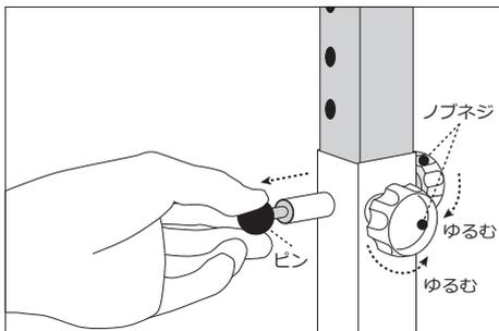
2カ所のノブネジをゆるめ、手すりの両端を二人で持ちながら、ピンを引っ張り、ロックを解除してください。
