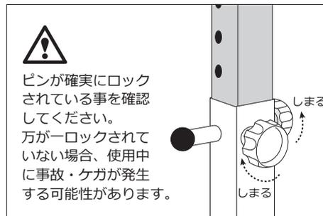
支柱に空いている穴にピンが入ることにより、高さがロックされます。ご希望の高さに調整し、ノブネジをしめ固定してください。
