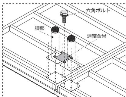
脚部組立時、左図のように脚部・連結金具の順番で共締めしてください。
