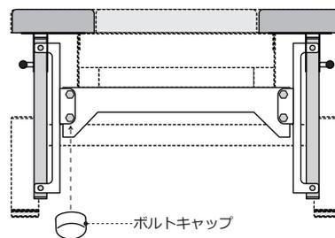
③六角ボルトを締め付けた後、ボルトにボルトキャップを被せてください。
