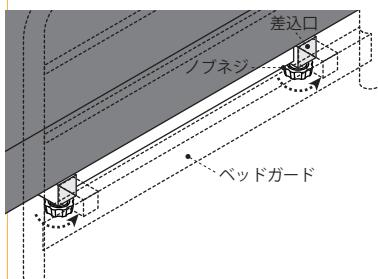
差込口にベッドガード・平行棒を差し込み、ノブネジ（2カ所）をしめ、しっかり固定してください。ガタつきや脱落の原因となります。
