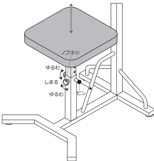
2ヶ所のノブネジをゆるめ、座部を上から少し押さえながら、ピンを引っ張り、座部の高さを調節してください。支柱に空いている穴にピンが入ることにより、高さがロックされます。ご希望の高さに調節し、ノブネジをしめ固定してください。
