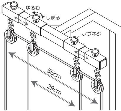
ノブネジをゆるめることで、滑車幅を 29 ～ 56cm の範囲で無段階に調節することができます。ご希望の位置に調節後、ノブネジをしめ固定してください。
