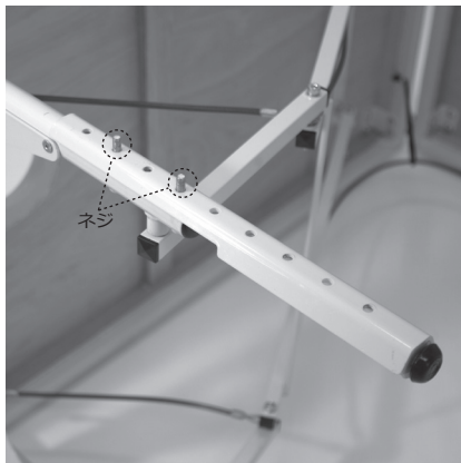
④ご希望の高さに外脚を調節し、外脚の穴(2カ所)に内脚のネジを差し込んでください。
