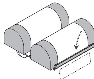
①ロールペーパーを引き出します。 ②上図のようにロールペーパーを丸棒の下側に通します。
