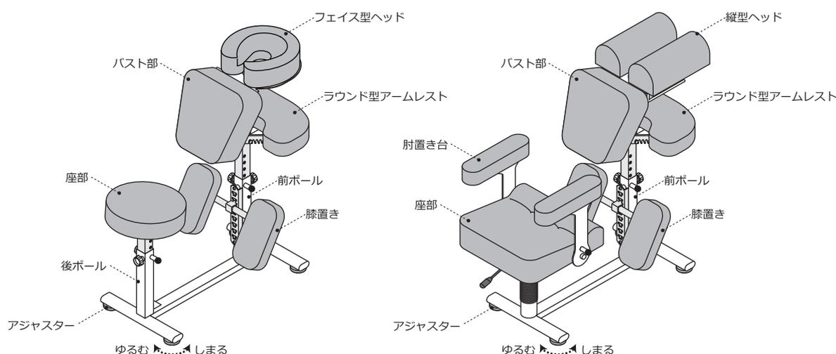
設置後、床との隙間により安定しない場合は、アジャスターで微調整して安定させてください。
