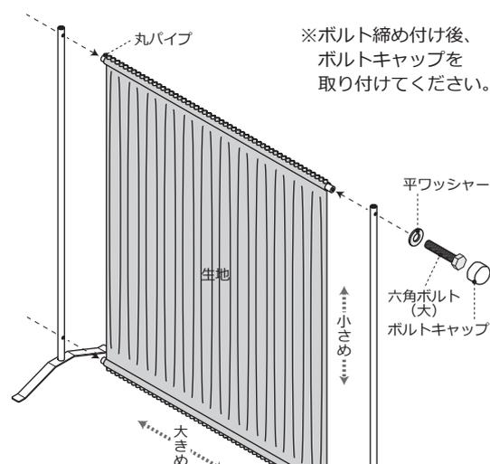
※ボルト締め付け後、ボルトキャップを取り付けてください。
