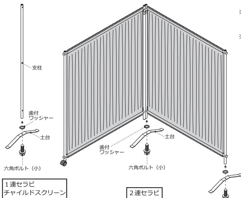
②下図のように生地を両端に丸パイプを通し、支柱と丸パイプを組み立ててください。
