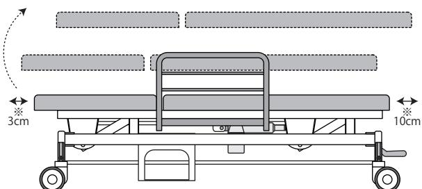
●本製品は垂直に昇降しません。前後に円弧を描きながら昇降しますので、左記可動図の作動範囲（※印）以上を壁、または人から離して設置してください。
