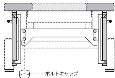
③六角ボルトを締め付けた後、ボルトにボルトキャップを被せてください。
