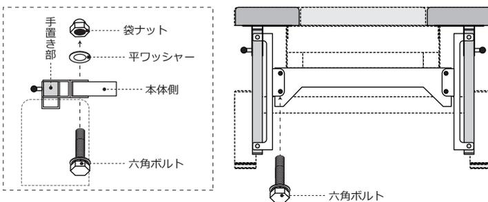
②手置き部の穴と本体側の穴の位置を合わせて、六角ボルトを通してください。ボルトの先には平ワッシャー・袋ナットの順番でしっかり締め付けてください。
