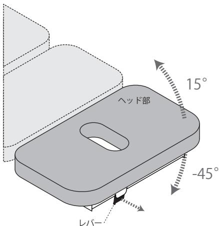
レバーを手前に引くことで、ヘッド部の角度調節（15°～-45°）をすることができます。ご希望の角度でレバーを離すと、固定できます。
