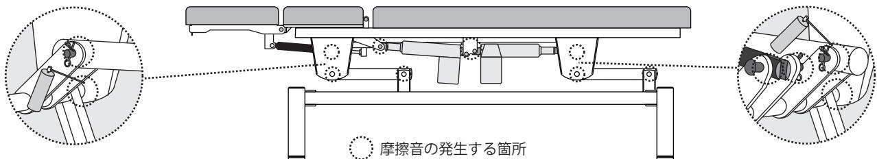
● 市販の潤滑スプレー又はグリーススプレーで、3ヶ月を目安に左記の可動部分に適量を吹き付けてください。吹き付けを怠ると、がたつきや摩擦音の原因となります。
