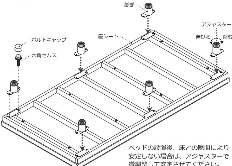
ベッドの設置後、床との隙間により安定しない場合は、アジャスターで微調整して安定させてください。
