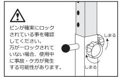
支柱に空いている穴にピンが入ることにより、高さがロックされます。ご希望の高さに調整し、ノブネジをしめ固定してください。
