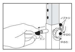
2 カ所(合計6ヶ所)のノブネジをゆるめ、手すりの中央・両端を三人で持ちながら、ピンを引っ張り、ロックを解除してください。
