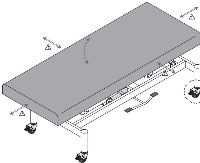
●油圧ポンプの構造上、ベッドを昇降させることにより油圧ポンプ内の油に気泡ができることがあります。気泡は時間が経つと破裂し、その反動によりベッド高が最大5cm程度下がることがあります。その際には、ベッドを一番上から一番下に下げる動作を5~6回程度繰り返してください。それにより油圧ポンプ内の気泡を除去することができ、ベッドが自然に下がることを防止できます。また、フットペダルを使用せずにベッドを持ち上げて高さ調節された場合にも油圧ポンプ内の油に気泡ができることがありますのでご注意ください。
