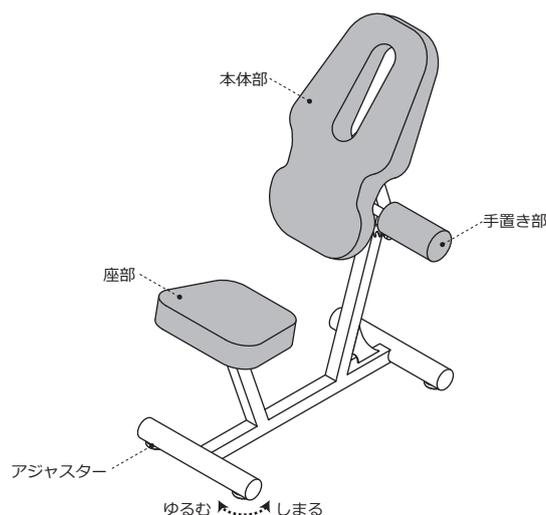
設置後、床との隙間により安定しない場合は、アジャスターで微調整して安定させてください。
