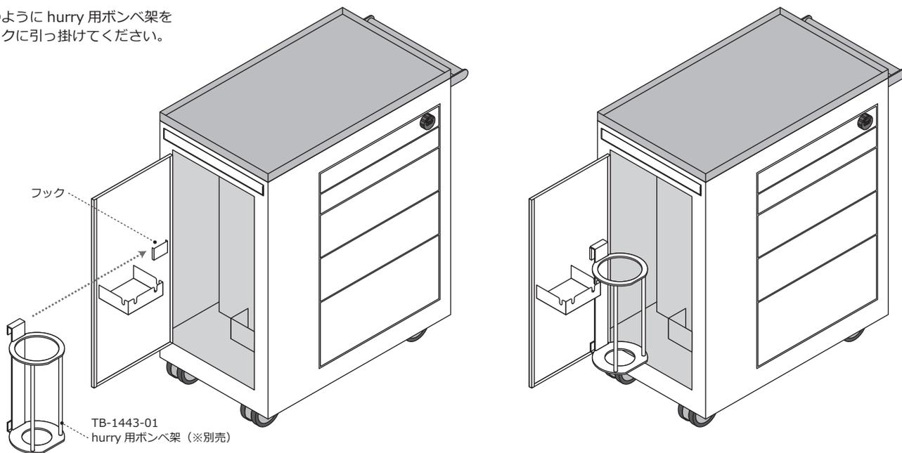
図のように hurry 用ガードル架を付属の皿ネジで取り付けてください。組ネジは、扉を開け裏側から取り付けてください。
