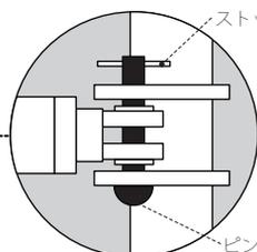
※ ピンを外す前に、ベッドの脚部を揺すってモーターが突っ張っていない状態にします。その後、ストッパーピンを外し、ピンを外してモーターの交換をしてください。
