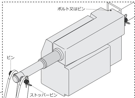
※ピンを外す前に、ベッドの脚部を揺すって、モーターが突っ張っていない状態にします。その後ストッパー・ピン、ピンを外してモーターの交換をしてください。
