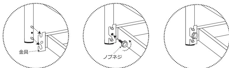
①ヘッドフレーム（フットフレームも同様）を左図のように、金具にひっかけてください。
