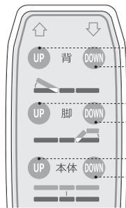
UP を押している間、背部の角度が上昇します。離すと停止します。
