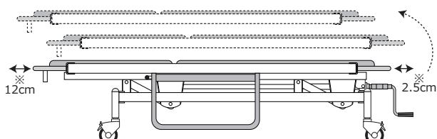
● 本製品は垂直に昇降しません。前後に円弧を描きながら昇降しますので、左記可動図の作動範囲（※印）以上を壁、または人から離して設置してください。
