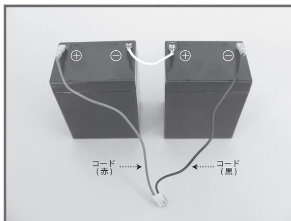
② 上記画像のように接続線とジャンパー線をバッテリーに接続します。※ 接続線の赤色は+端子、黒色は-端子に接続してください。
