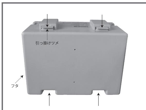
③ コントロールボックスのバッテリーのフタを外します。4つの引っ掛けツメを押しながら、フタを引き上げます。※ しっかりと引っ掛けツメを押しながらフタを引き上げてください。不十分ですと引っ掛けツメが破損する恐れがあります。
