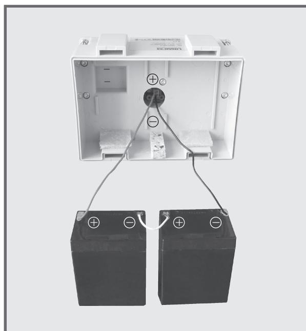
④ 今までのバッテリーを取り外し、上記画像のように先程準備したバッテリーの接続線を本体のコネクターに差し込みます。※ コネクターの差し込み方向に十分注意してください。コントロールボックスが焼損し使用不能になります。
