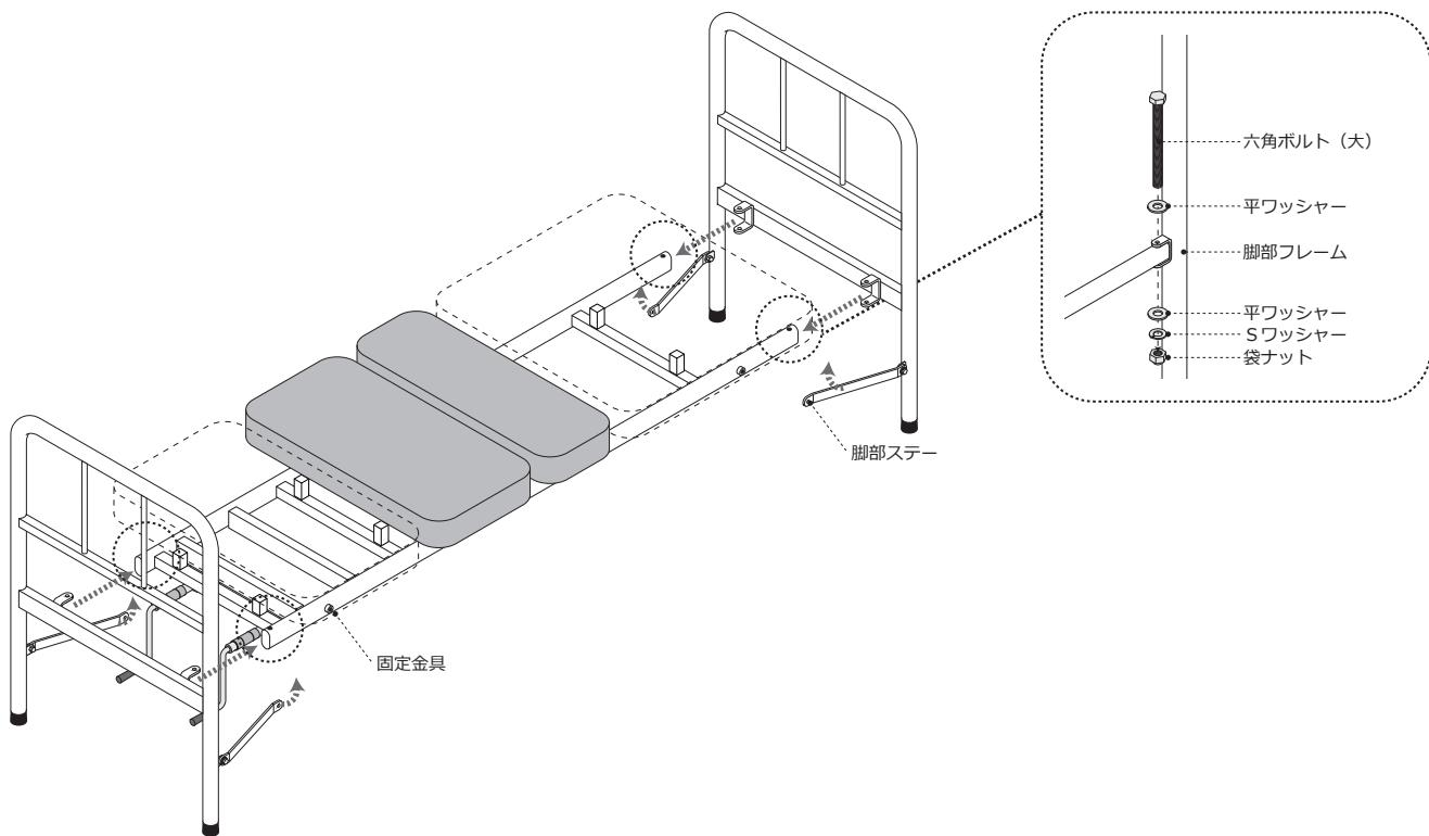
②下図のように、スチール枠の固定金具と脚部ステーを六角セムスで仮止めします。全てのボルトを仮止め後、①・②で仮止めしたボルト、○部分のボルトを付属のスパナでしっかりと固定してください。
