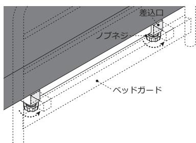
差入口にベッドガードを差し込み、ノブネジ（2カ所）をしめ、しっかりと固定してください。ガタつきや脱落の原因となります。
