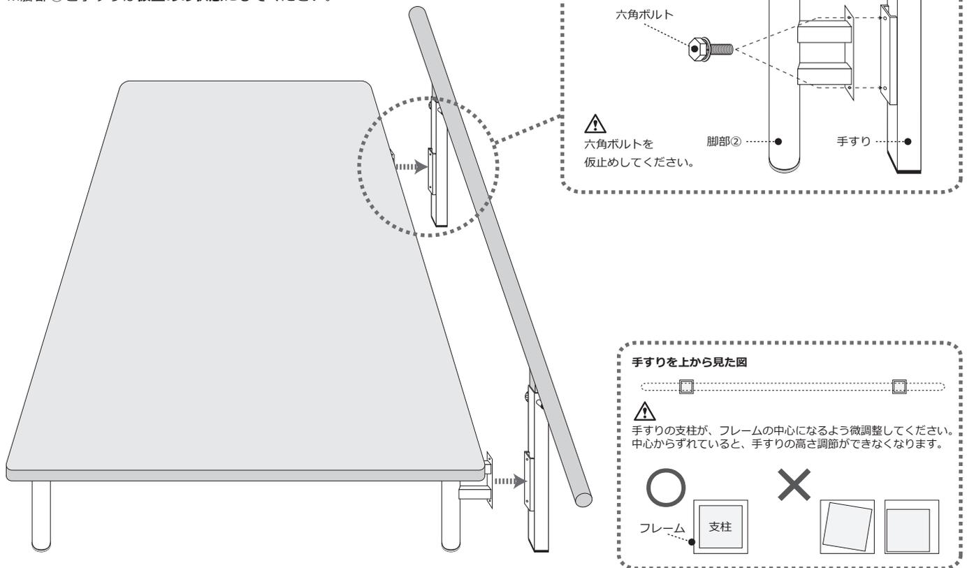
③手すりの支柱がフレームの中心になるよう微調整した後、脚部②と手すり、脚部②と天板の順番で、六角ボルトをしっかりと止めてください。
